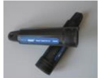
Figure 4 thermographe enregistreur
